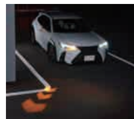
方向指示器と連動して路面投影するランプ
