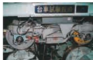
鉄道用台車試験設備
