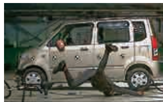
自動車に対する乗用車の追突実験とそのコンピュータシミュレーション
