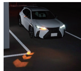
方向指示器と連動して路面投影するランプ
