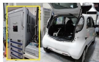
バーチャル環境で実走行と同様な バッテリーの挙動を模擬できるHILS装置
