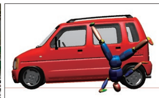
自転車に対する乗用車の追突実験とそのコンピュータシミュレーション
