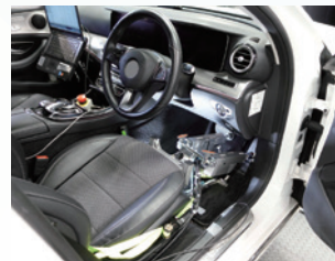
交通安全環境研究所で開発した 自動アクセル・ブレーキ操作装置
