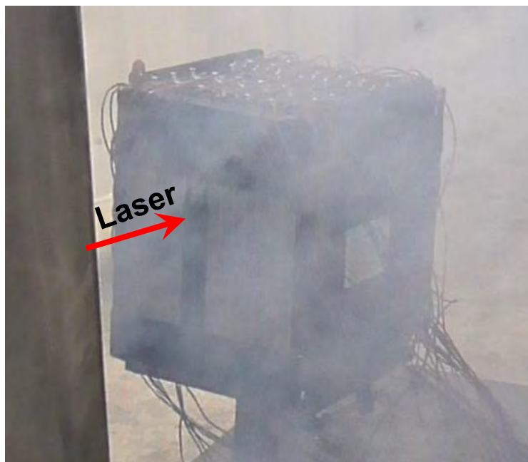
任意のパウチセルをレーザ照射にて熱暴走
