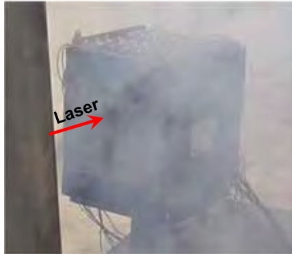
任意のパウチセルをレーザー照射にて熱暴走
