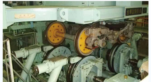
鉄道用台車試験設備
