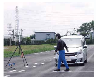
衝突被害軽減ブレーキ実験
