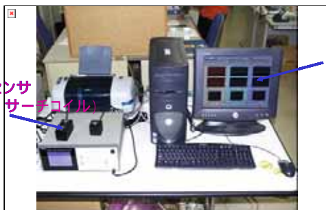
交通研が開発した磁界測定器
