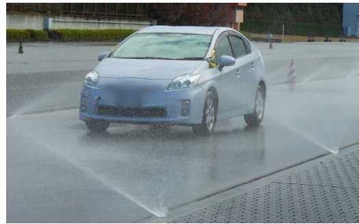
図5-2 走行路の散水状況
