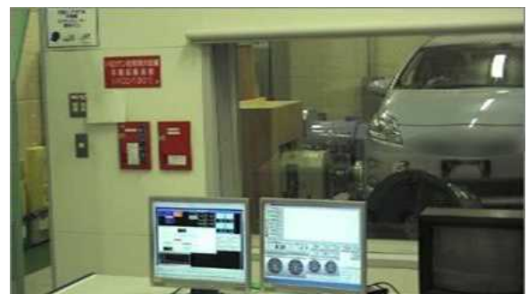
図4-1 実車走行模擬装置による台上走行実験
