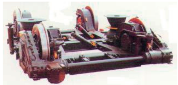
図：熊本市交通局 LRV の台車形状
