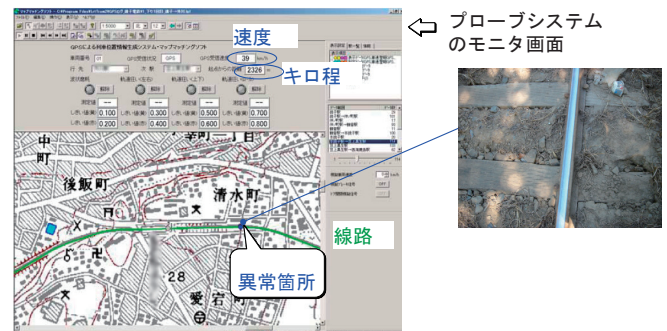
図：プローブシステムにより検知された異常箇所
