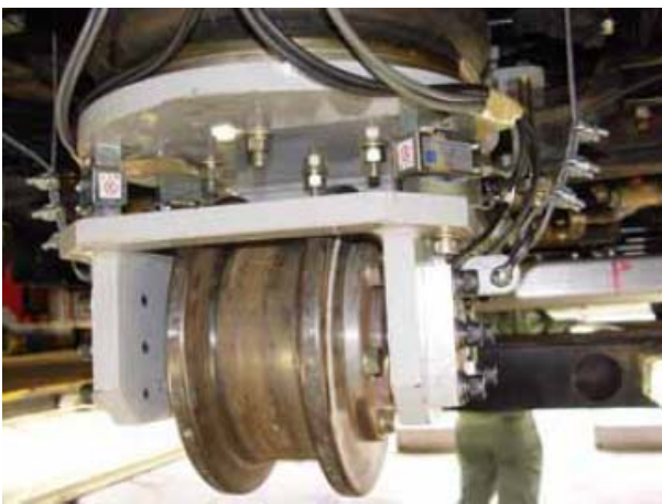
写真8 車両に内蔵している逸脱防止装置
