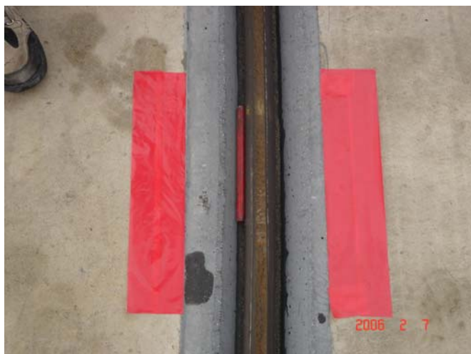
写真9 案内レール上の異物挿入例
