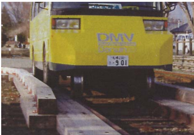
写真 14 モードインターチェンジ部走行中の DMV
