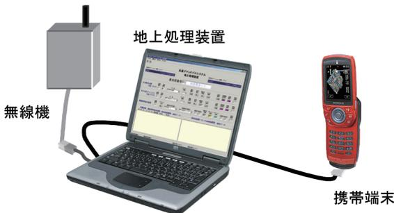
図 10 パケット通信構成例
