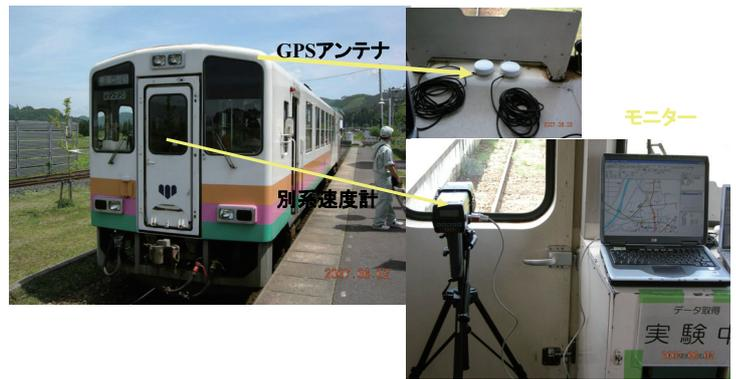
写真 3 GPS とドップラーレーダによる速度検知
