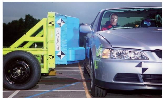
図 1 衝突車、被衝突車の実験前セッティング状況
