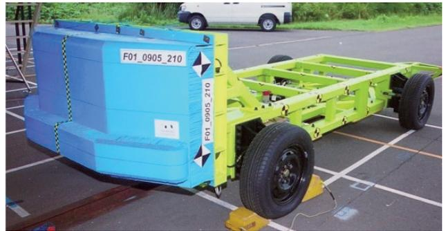
図4 Test No.2に衝突車として使用した IIHS MDB の外観
