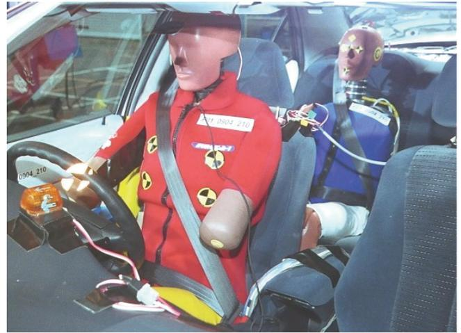
図 6 ダミーの搭載状況 (Test No.1)
