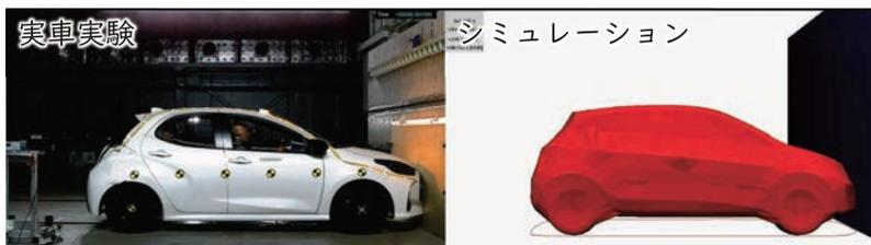
車両後部が持ち上がるようにピッチングし、壁から離れながら後部が着地
