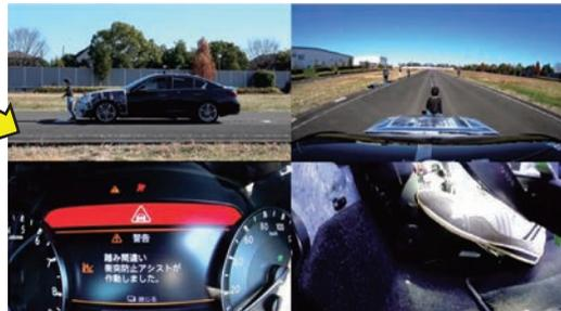
UN-R152においてドライバの**意図しないAEBSの作動を解除**できるようにするため、AEBS作動後にアクセルペダルが大きく踏み込まれた場合にはAEBSの制動を終了（急加速）してもよいとされる
