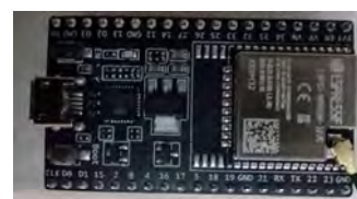
A) 組み込みマイコン(ESP32)
