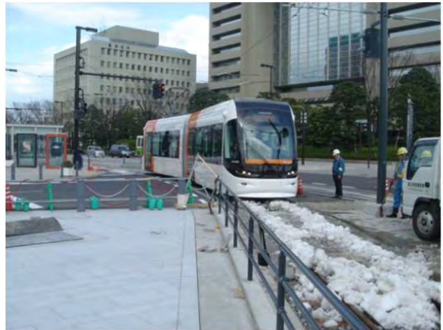
軌道上の雪撒き状態での列車検知試験
