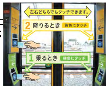
▲車両の全扉の両側に設置されたICカードリーダー
