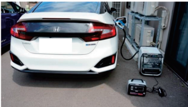
老人ホームでエアコンや小型蓄電池の充電に使用 出典:本田技研工業株式会社
