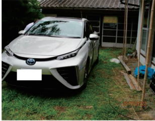
地域を巡回し、個人宅で照明、電子レンジ等に使用 出典:トヨタ自動車株式会社
