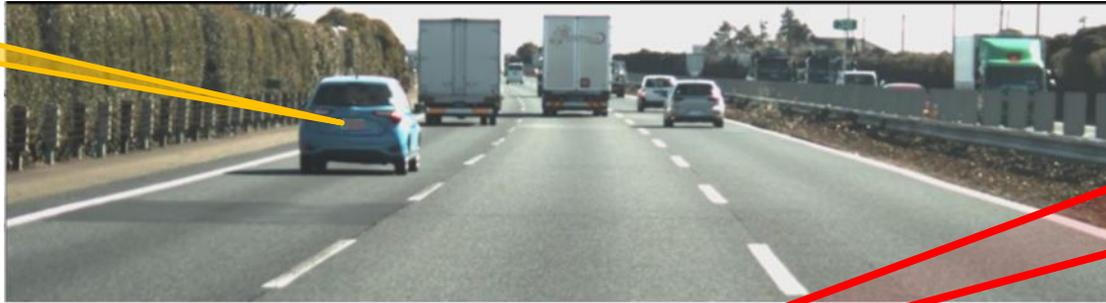
対象車の前輪のうち車線変更先の車線に最も近いものが、車線変更先の車線との境界線に到達した時点
