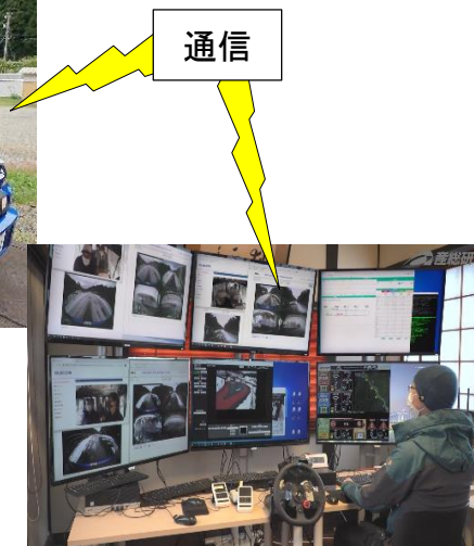
遠隔監視・操作室
