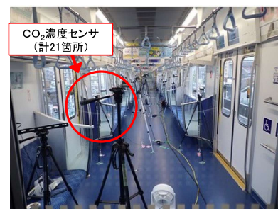
車両に充填したCO 2 の濃度の走行時の変化によって換気量を測定
