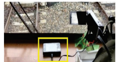
使用した小型情報端末 W58 × D94 × H16mm 500g
