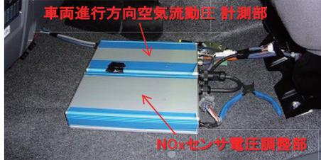
アナログ-CAN信号変換器の取り付け状況
