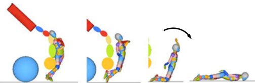
【挙動6】前方押し倒し挙動であり、歩行者は車から離れる向きに回転する。
