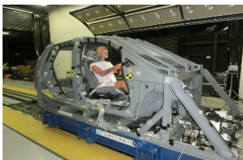
スレッド試験の状況
