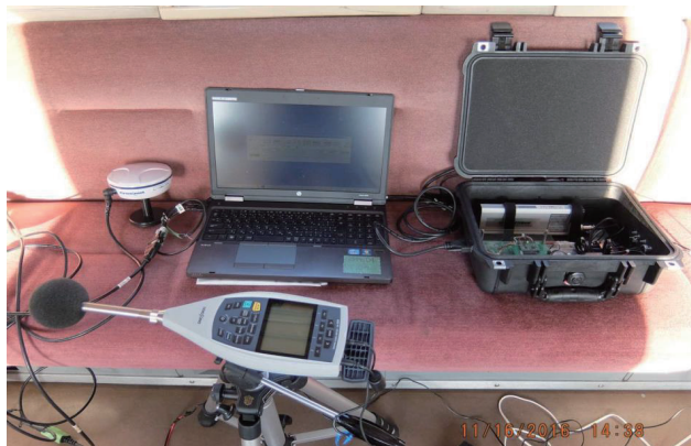
可搬型プローブの広帯域化改造
