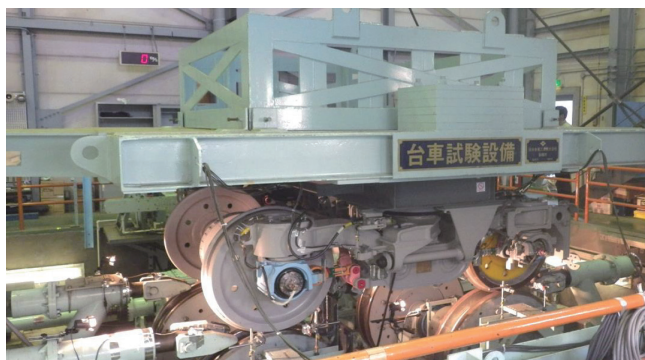
銀座線1000系車両用SC101形台車
