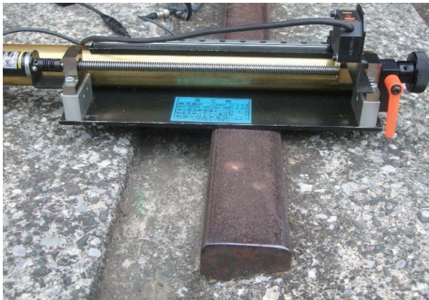
レーザセンサを用いた簡易な 2次元形状測定装置を製作
