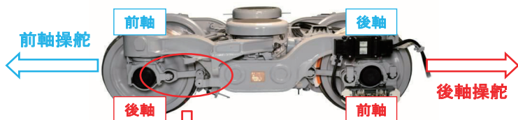
銀座線1000系車両用SC101形台車
