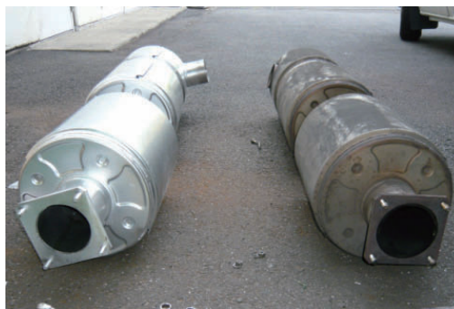
SCR触媒を含む排気マフラー、新品(左)と26万キロ走行後(右)
