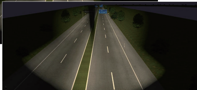
LEDの選択点灯により、対向車に光が当たらない
