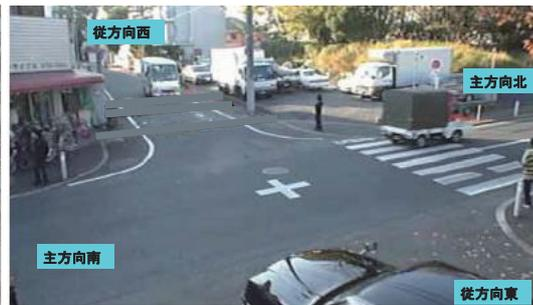
ビデオカメラ、調査員目視、トラフィックカウンタ等により交通流、速度、ドライバー挙動等を調査、モデル化し、シミュレーション設定に利用
