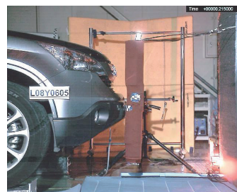
バンパーの歩行者脚部保護性能試験
