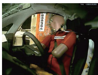
側面衝突試験 ※1box, SUV車も考慮した試験 ※地上構造物(電柱など)との衝突試験
