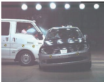
側面衝突試験 ※1box, SUV車も考慮した試験 ※地上構造物(電柱など)との衝突試験
