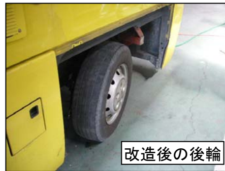
4輪自動操舵化への改造
