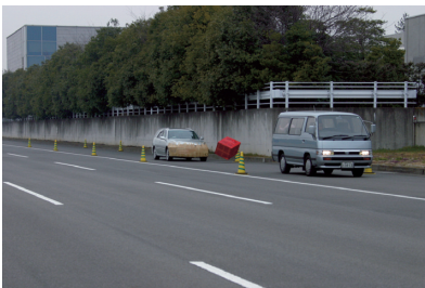
障害物飛び出しにおける急制動の実験場面
