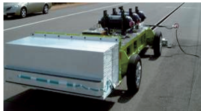
試験台車による前面衝突実験
