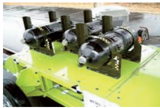
容器・配管の固定
