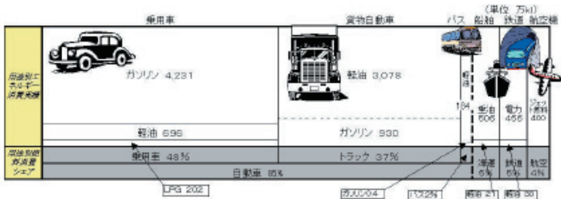
図 XX-2 運輸部門における用途別エネルギー消費内訳 乗物の中でエネルギー消費のほとんどは乗用車と貨物自動車 で占められる。鉄道の5%の僅か一部を路面電車が占めている(交 通関係エネルギー要覧 2000 年度)
