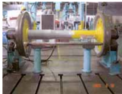
測定用の特殊車輪を備えたPQ輪軸
