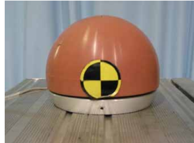
頭部インパクト 大人用(直径165mm、質量4.5kg) 子供用(直径165mm、質量3.5kg)
