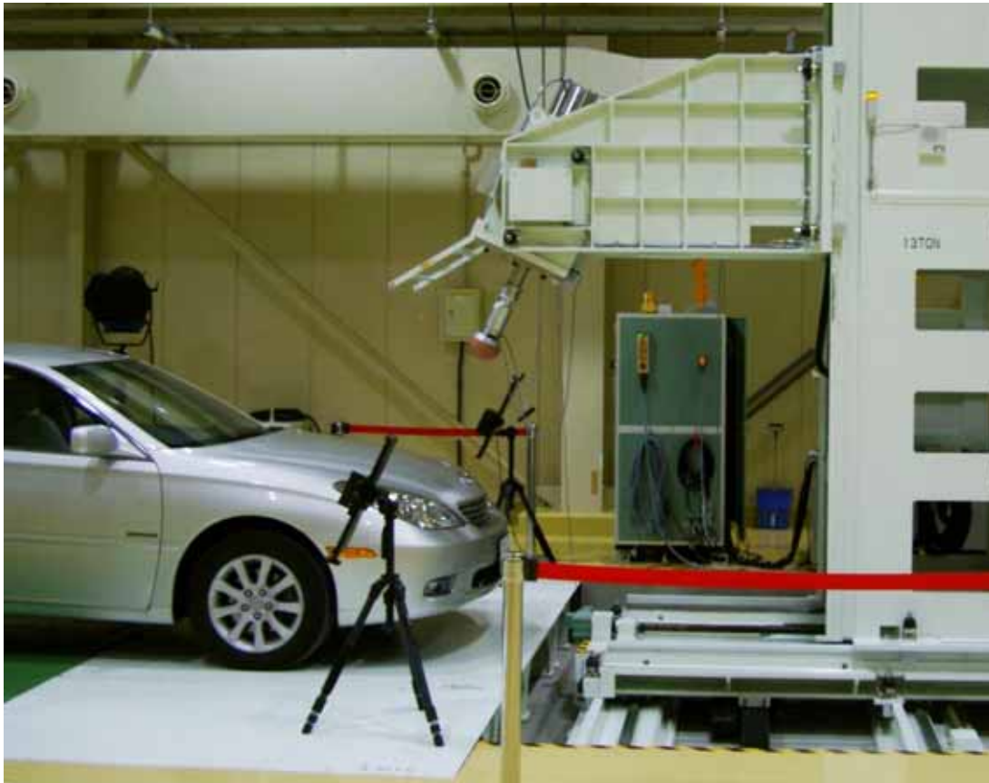
頭部インパクト 大人用(直径165mm、質量4.5kg) 子供用(直径165mm、質量3.5kg)
