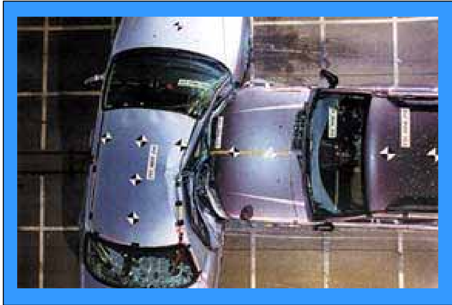
SUVと一般乗用車の実車 による側面衝突実験
