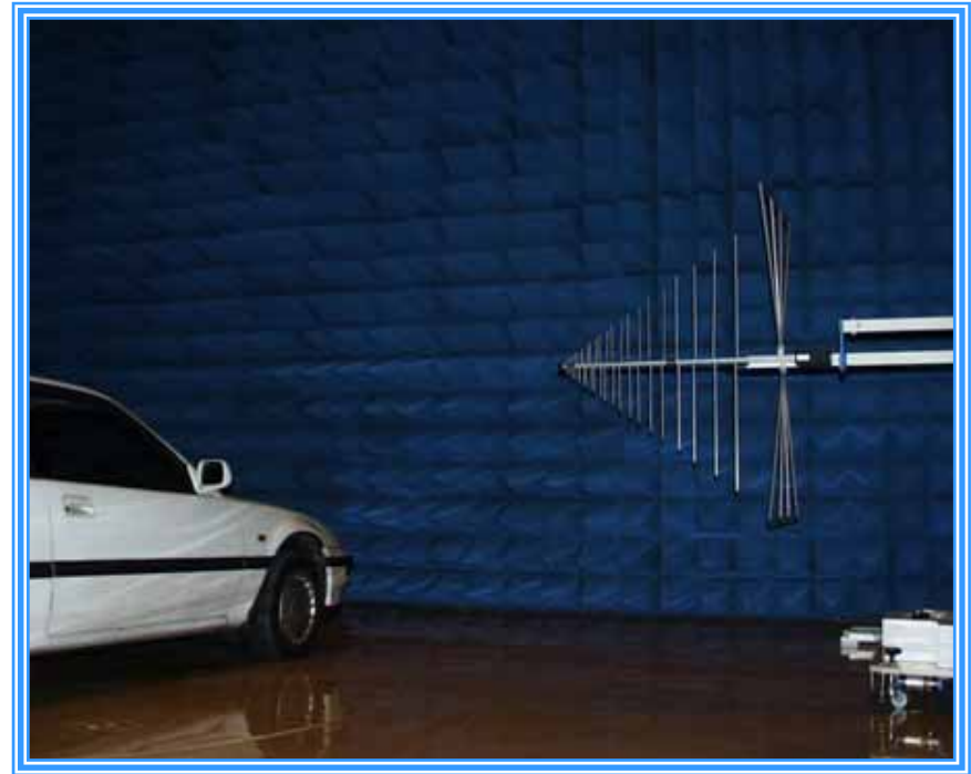
耐電磁波性能に関する測定
