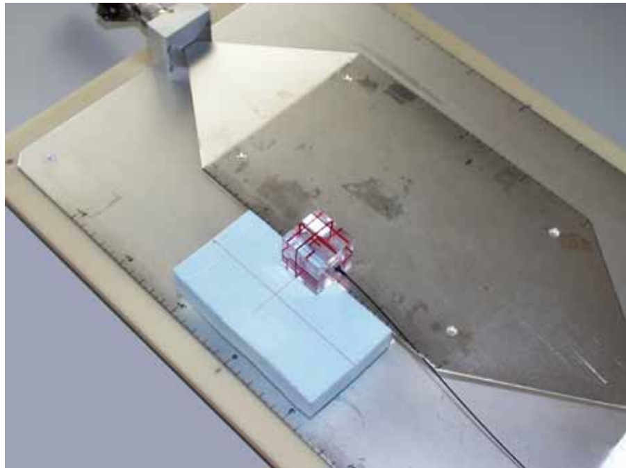
光電界センサによる電界強度の測定状況(治具の校正)
