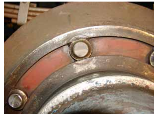
ホイールボルト折損状況
