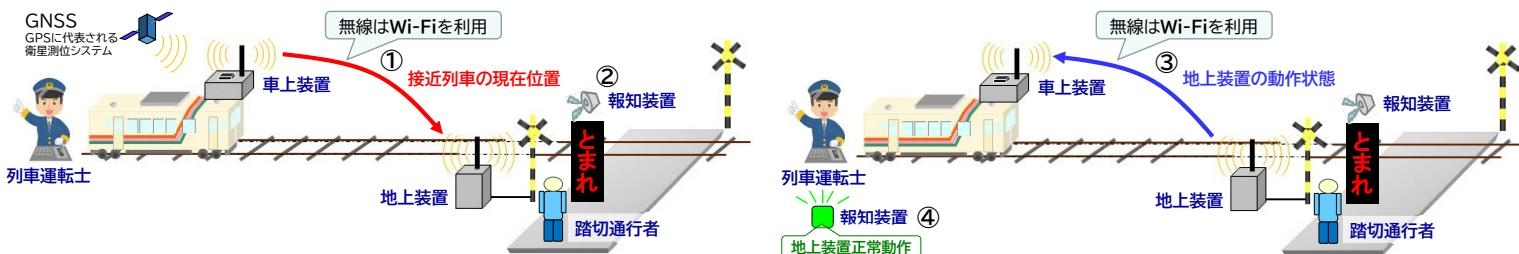
システムの基本構成は「車上装置」と「地上装置」(ただし、車上装置～地上装置間の通信距離を延長するために「中継装置」を設置する場合もあり)
