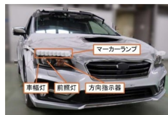
図 1 評価用マーカーランプと実験車両の灯火器
