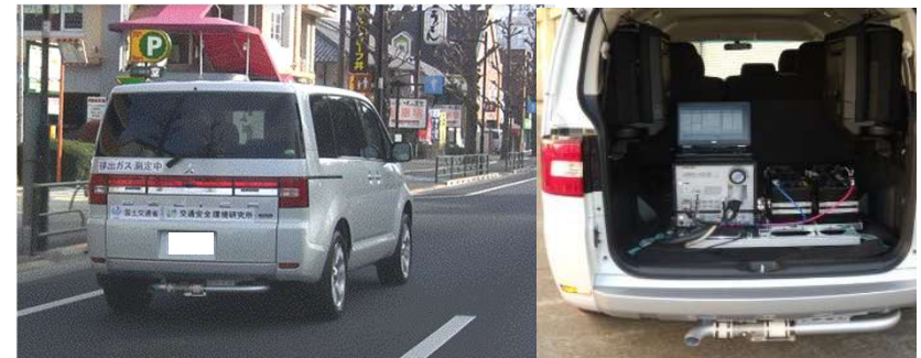
車載式排出ガス測定システム(PEMS)を用いた路上走行排出ガス試験
