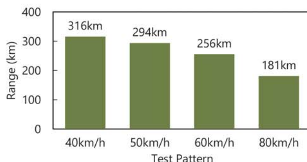
図2 各車速における航続距離測定結果 (車両#1)
