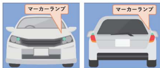
図 1 自動運転マーカーランプの取付例
