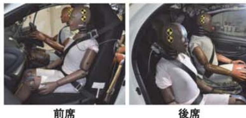
図2 ダミー搭載状況
