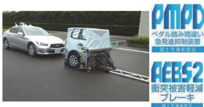
図2 衝突被害軽減ブレーキ性能評価試験の様子
