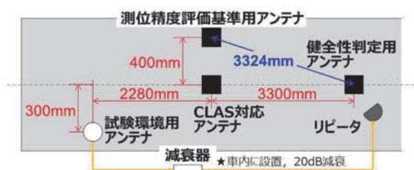
図2 実車実験における機材構成
