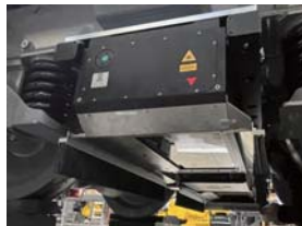
分岐器の車上計測システム開発例 出典: https://dmatrino.it/tunout-crossing-measurement-system/
