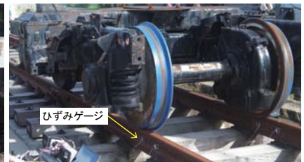
輪重の測定状況(空車)
