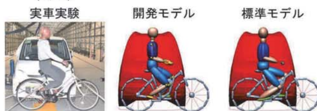
図 4 自転車衝突実験の配置
