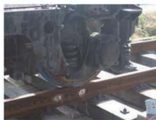
図4 輪重の測定状況
