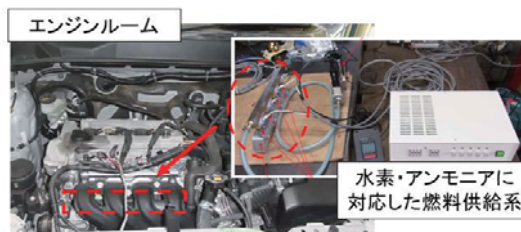
Fig.1 燃料供給系改造状況
