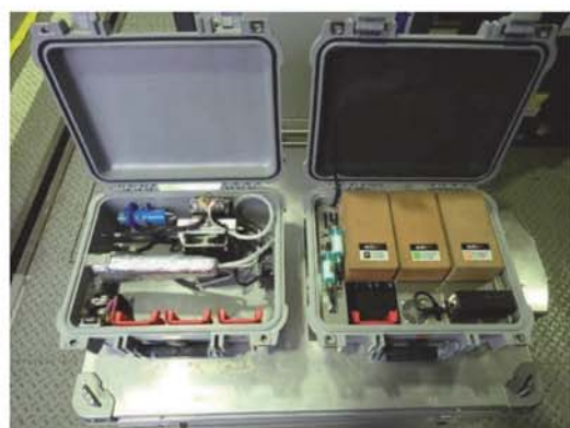
図2 小型車載式排出ガス測定システム（ミニ PEMS）
