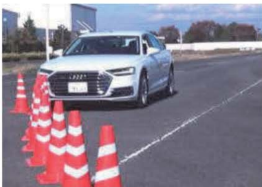
図3 自動運転レベル2運転支援システムの調査 (工事現場を模したカラーコーンに対する検知と反応を調査)
