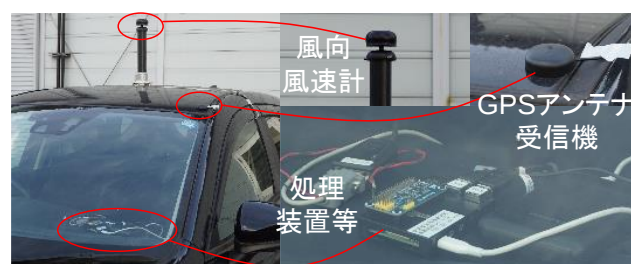
図6 自動車による動作確認試験の様子
