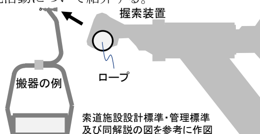
図1 握索装置の一例（模式図）
