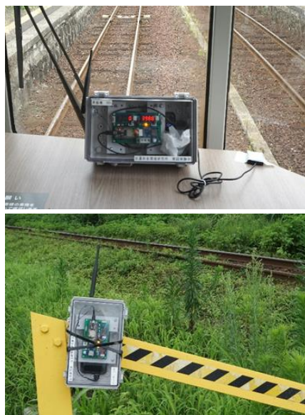
図 1 検討した第 4 種踏切支援装置 (上：車上装置、下：地上装置)
