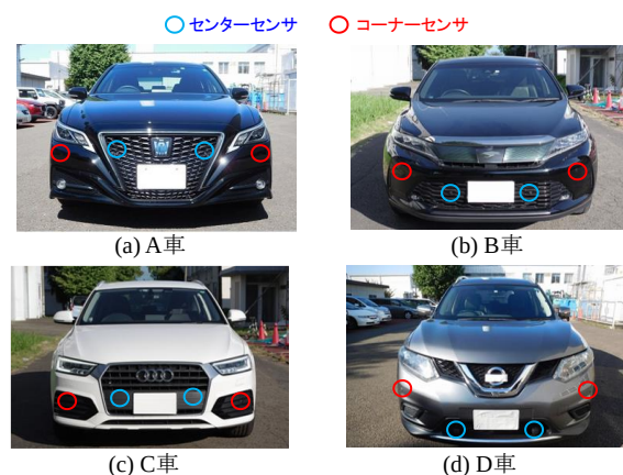
図 1 車両前方ソナー装着状況概観
