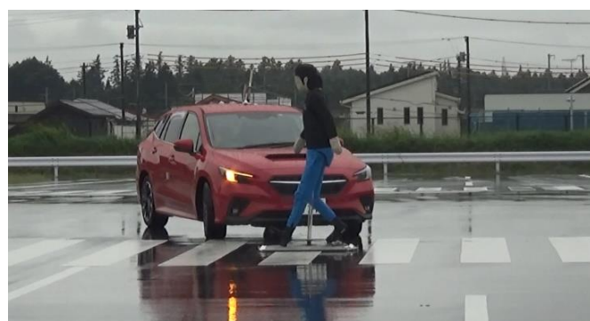
図 2 自動運転レベル2運転支援システムの調査 (交差点での衝突被害軽減ブレーキの機能確認(右折))
