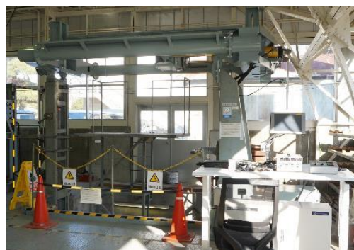
図2 更新後の耐滑動力試験装置の外観
