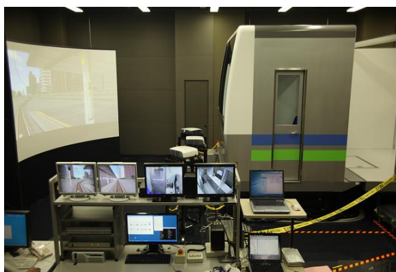
図1 列車運行システム 安全性評価シミュレータ
