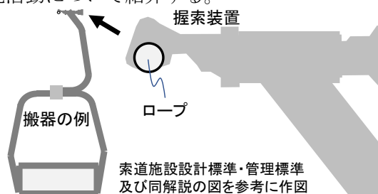
図1 握索装置の一例（模式図）
