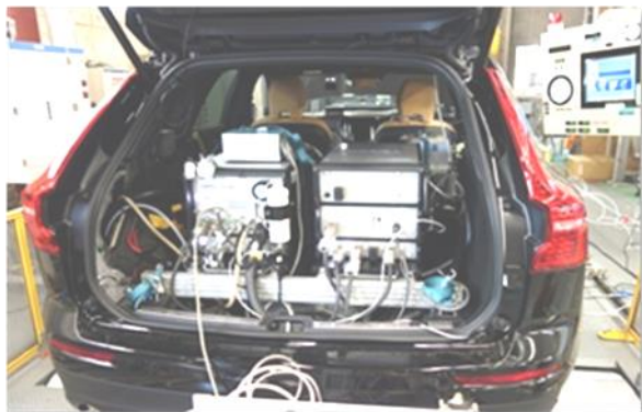
図1 車載式排出ガス測定システム (PEMS)
