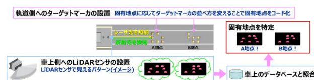
図 6 ターゲットマーカ方式による位置検知
