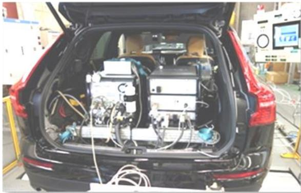
図1 車載式排出ガス測定システム (PEMS)
