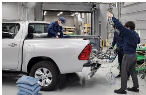
図 3 路上走行時の排出ガス試験研修の様子
