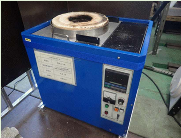
電気ルツボ炉を使用して加熱
