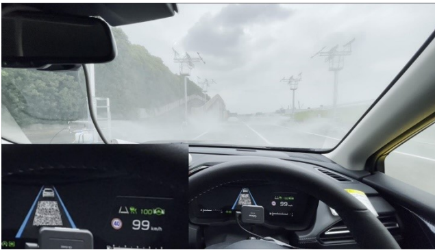
(a) 先行車/左右白線を認識した状態
