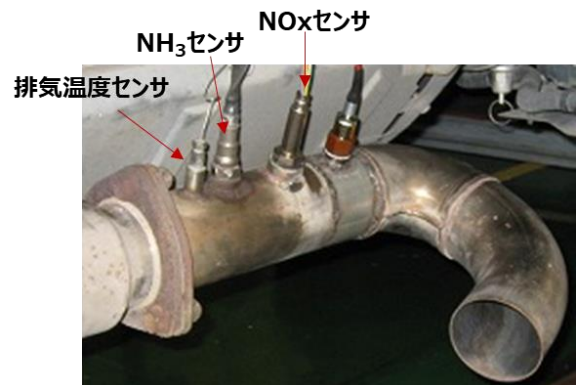
図 1 SEMS のテールパイプへの取付状況
