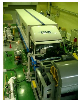
図 4 重量車のシャシダイナモ試験の例 (車両は過去の次世代事業で開発したディメチルエーテル (DME) 車)
